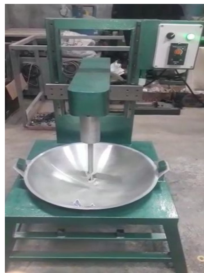
Gambar : Mesin Penyangrai Jahe
